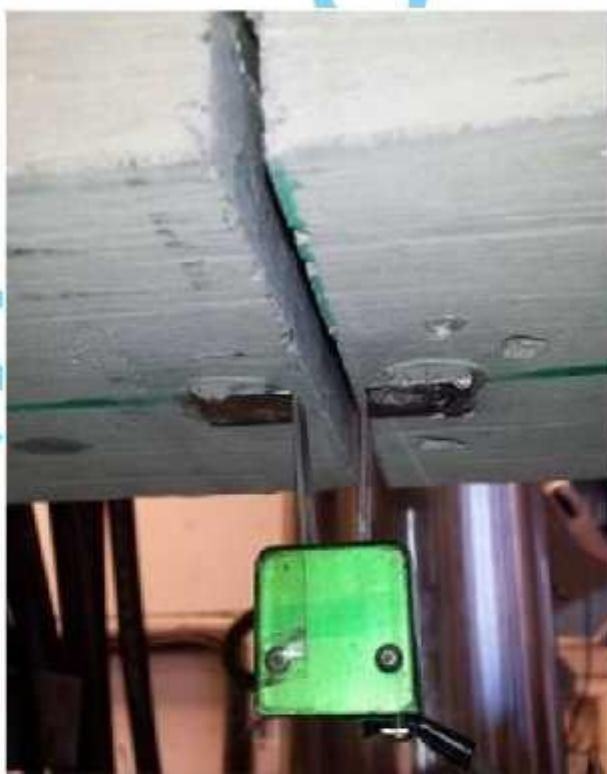
Hình 13 - Cảm biến đo mở rộng vết nứt CMOD
