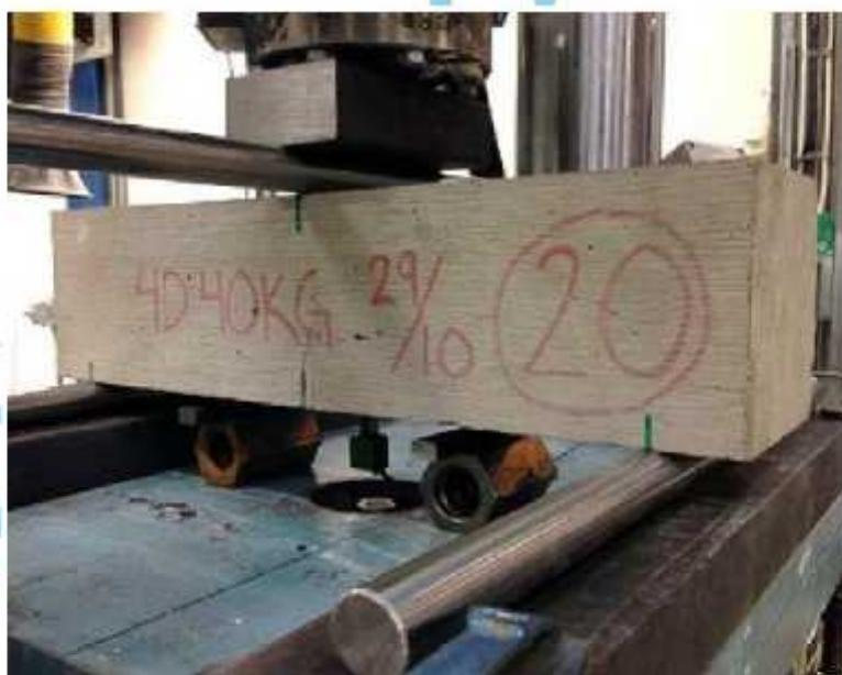
Hình 11 - Thí nghiệm uốn dầm
