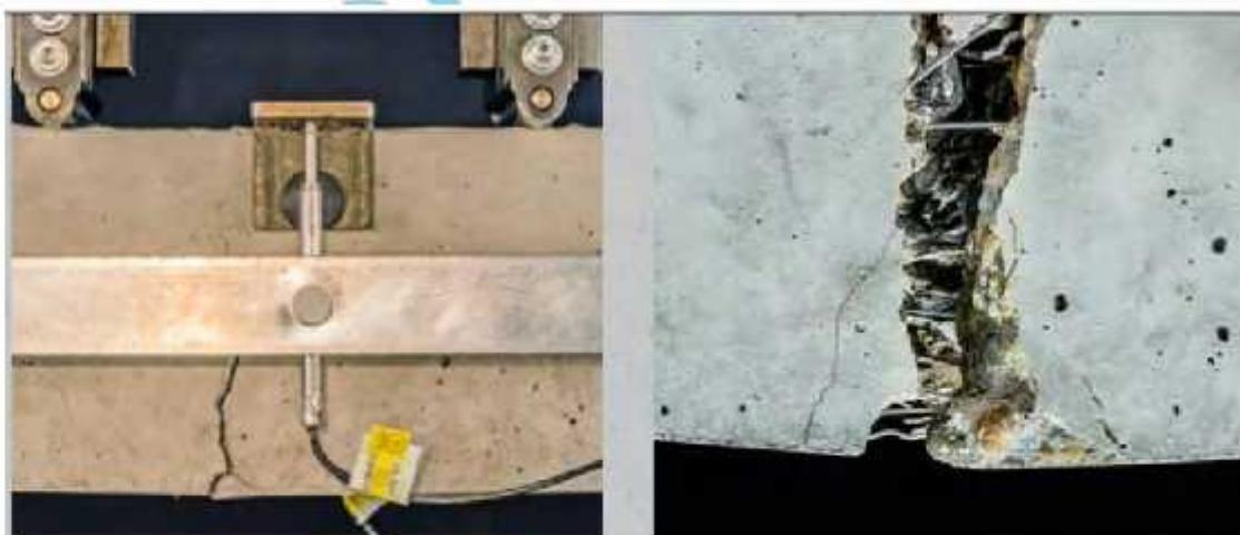
Hình 4 - Vết nứt trong bê tông khi có sợi thép
