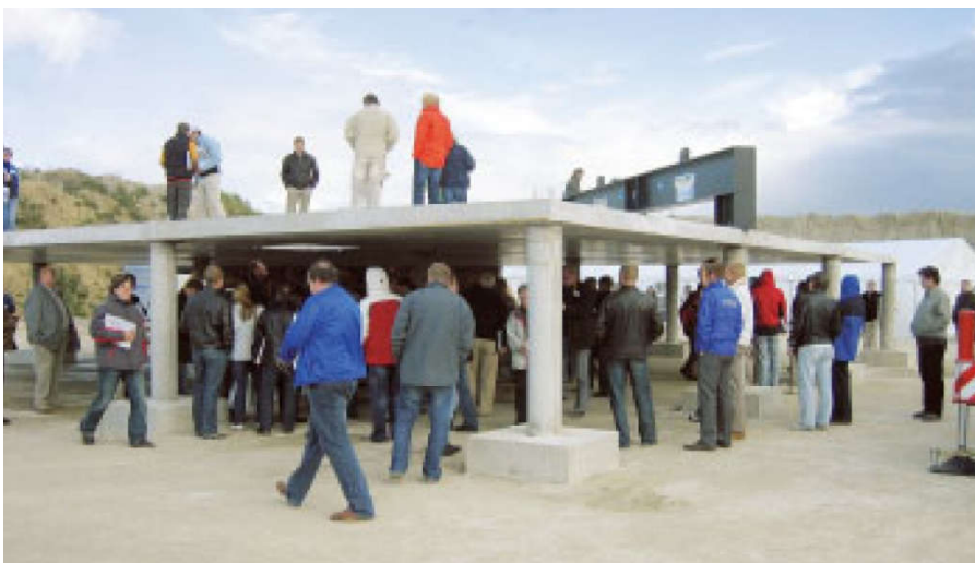
Kết cấu sàn bê tông trên cột (Thí nghiệm kích thước thực)
