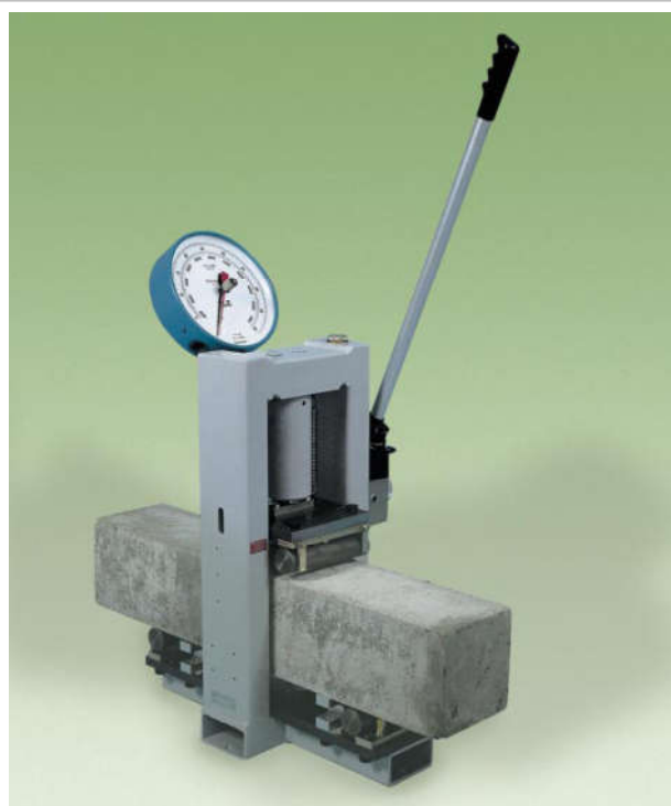
Thí nghiệm uốn dầm 3 điểm (Xác định ứng suất uốn dư)
